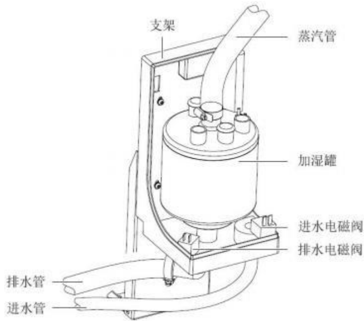
图 6.2.5 电极加湿器示意图
